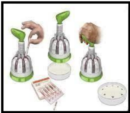
Малюнок 9. Схема роботи дискового диспенсера для викладання картриджів з антибіотиками
