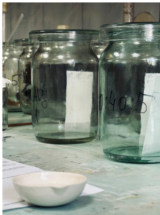
Скляна камера для тонкошарової хроматографії
