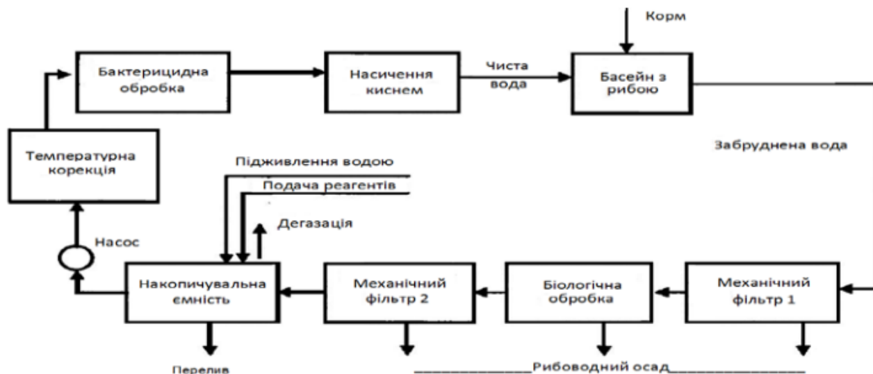
Рис. 1.1 Рециркуляційна система для вирощування риби [5]
